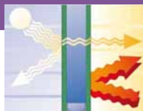
Il vetro isolante per la protezione contro il sole e contemporaneamente per l'isolamento termico durante le stagioni più fredde.
