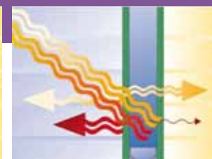
Il vetro isolante per l'isolamento termico durante l'estate.
